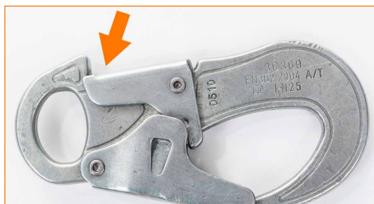
Connecteur à double gâchette avec gâchette de sécurité postérieure qui ne revient pas en position automatique.
