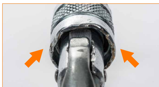
Connecteur avec bague de verrouillage à vis extrêmement détériorée.
