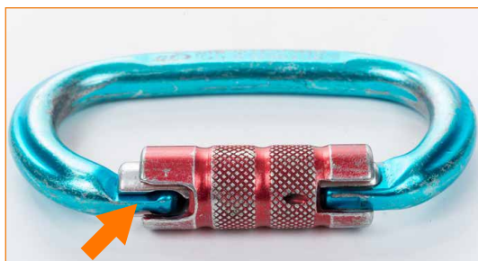
Connecteur avec bague de verrouillage qui ne revient pas automatiquement en position de blocage. ⚠ Lubrifier la bague de verrouillage en suivant les indications des instructions d'utilisation. Si le problème n'est pas résolu, mettre le produit au rebut.
