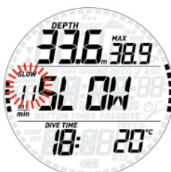
Si la vitesse de remontée est supérieure à 12 m/min à une profondeur plus importante que 12 m, l'écran affiche **SLOW DOWN!** et la valeur de la vitesse clignote. Si une vitesse supérieure à
