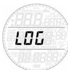
Le Smart peut enregistrer les profils d'environ 35 heures de plongée, avec une fréquence
