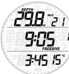
Une pression prolongée sur le bouton du haut permet d'entrer dans les enregistrements de la séance et de voir la profondeur maximale et la numérotation séquentielle de l'immersion en haut, la durée de plongée sur la ligne du milieu, l'intervalle de surface avant l'immersion et la température minimale de l'immersion en bas.
