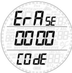
Le Smart vous permet de remettre à zéro la désaturation calculée par l'ordinateur. Toutes les informations de saturation des tissus relatives à une plongée récente seront remises à zéro et l'ordinateur considérera la plongée suivante comme une plongée simple (non successive). Cela est utile lorsque l'ordinateur est prêt à un autre plongeur qui n'a pas plongé dans les dernières 24 heures.
