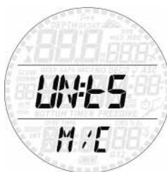
Vous pouvez choisir entre les unités métriques (profondeur en mètres, températures en °C) et impériales (profondeur en pieds, température en °F).
