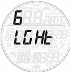
Le Smart dispose d'un rétroéclairage qui peut être activé au cas où la lumière ambiante serait faible. Le rétroéclairage est activé par une pression prolongée sur le bouton du bas. Au cours d'une plongée, le rétroéclairage restera activé pendant la durée définie dans ce menu. Vous pouvez choisir une durée de 1 à 10 secondes.
