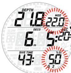
Une pression prolongée sur le bouton du haut confirme le passage à G2, une pression sur le bouton du bas annule changement de gaz et vous restez sur G1. Dans les deux cas, la concentration en oxygène du réglage s'affichera fixement dans le coin en bas à droite de l'écran, et sous 20 secondes la durée de la remontée est mise à jour afin de refléter la plus haute concentration en oxygène du gaz qui est respiré.
