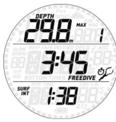
Si vous appuyez sur le bouton du haut, l'affichage passe à la profondeur maximale de la séance sur la ligne du haut, le temps de plongée maximal de la séance sur la ligne du milieu et la température minimale au cours de la séance sur la ligne du bas.
