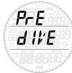
Une pression prolongée sur le bouton du haut permet d'entrer dans ce menu et met le Smart en mode prêt à plonger.
