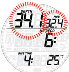
L'alarme continue jusqu'à ce que le plongeur soit suffisamment remonté pour que la pp<sub>O<sub>2</sub></sub> revienne dans les limites programmées.
