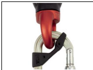
La forme, ovale et symétrique, permet de positionner le mousqueton de façon optimale. La barrette de maintien CAPTIV favorise la sollicitation du mousqueton selon le grand axe, limite le risque de retournement et le solidarise à l'appareil.
