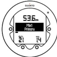
4. Ajustez la valeur PO<sub>2</sub> (pression partielle d'oxygène) en utilisant les boutons [DOWN] ou [UP], puis confirmez avec [SELECT].
