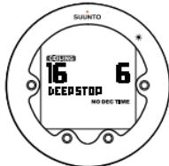
Le palier de profondeur est activé par défaut dans les modes **Air** (Air) and **Nitrox** (Nitrox). Pour désactiver le palier de profondeur :
